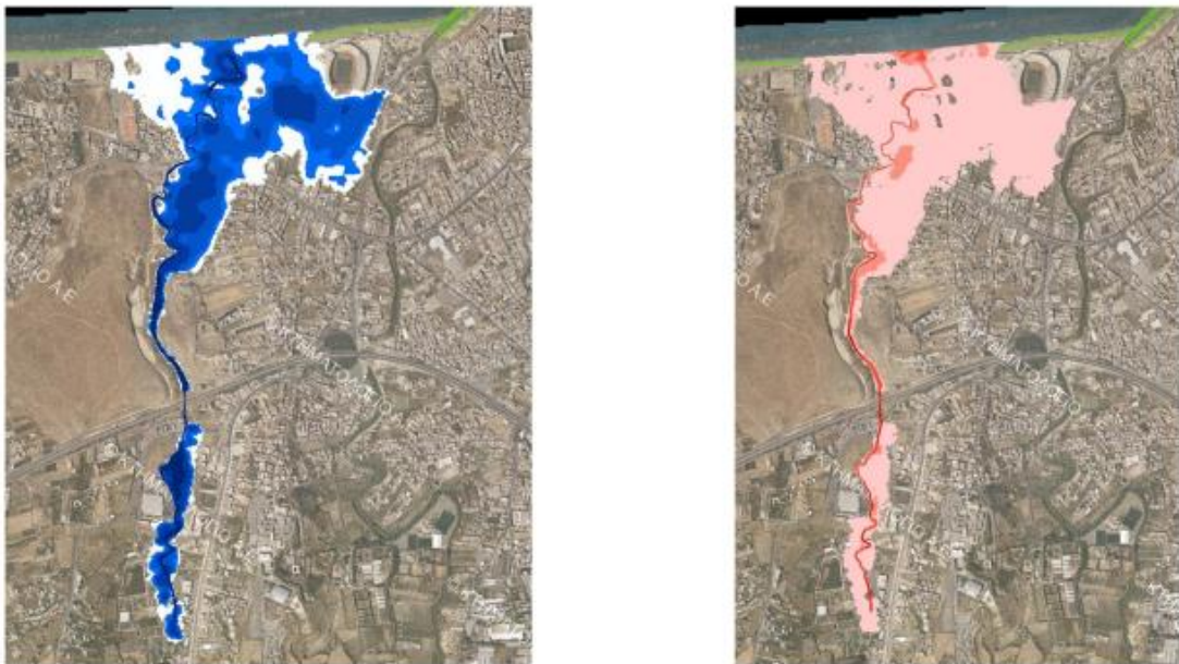
Σχήμα 3.62: Σχηματική απεικόνιση έκτασης - βάθους και ταχυτήτων ροής πλημμύρας του π. Ξεροπόταμου με περίοδο επαναφοράς T=100 ετών για μη μόνιμη ροή (MIKE FLOOD).
