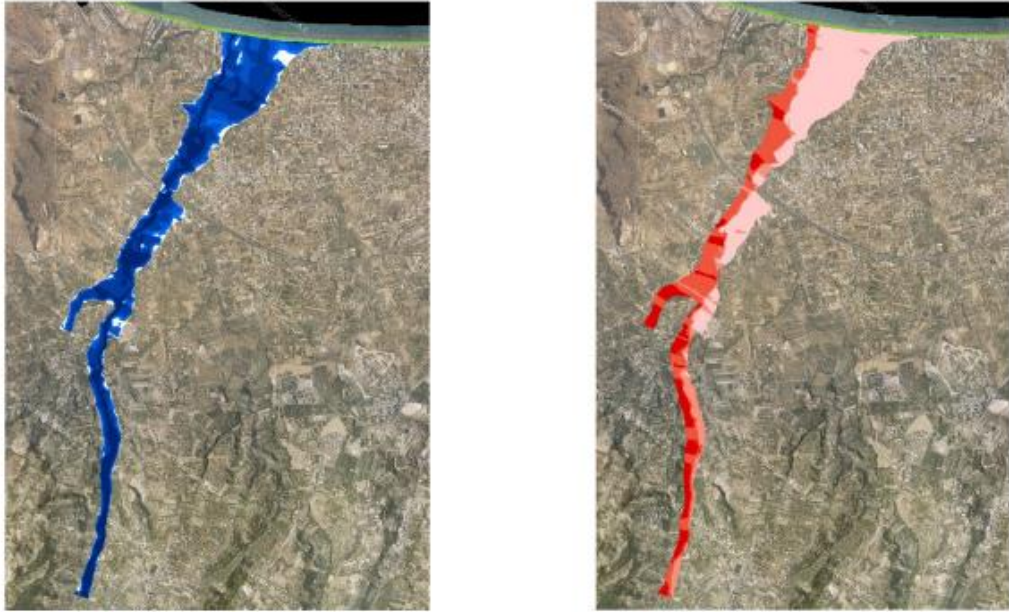
Σχήμα 3.52: Σχηματική απεικόνιση έκτασης - βάθους και ταχυτήτων ροής πλημμύρας του ρ. Γαζανός με περίοδο επαναφοράς T=100 ετών για μη μόνιμη ροή (HEC-RAS).
