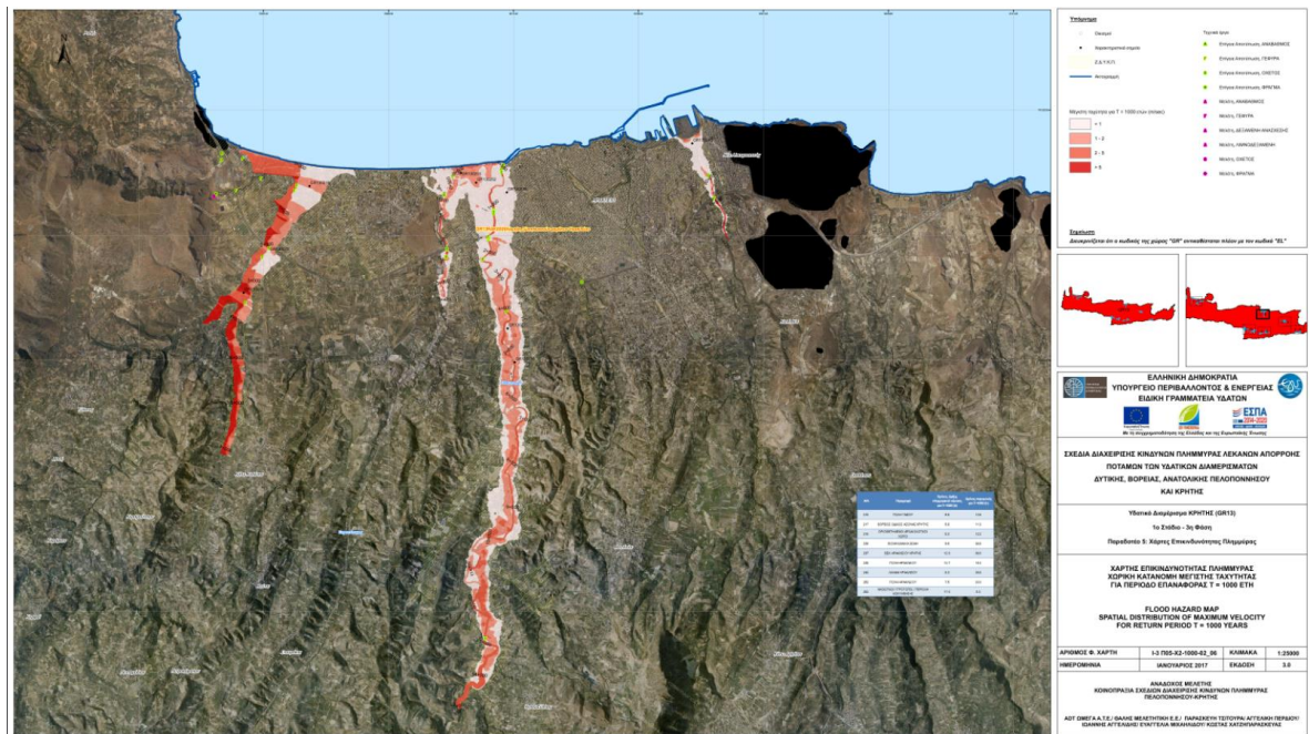
Εικόνα 21 Πινακίδα Χωρικής Κατανομής Μέγιστης Ταχύτητας Πλημμύρας για T=1000 έτη
